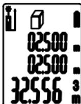
Efter avslutad tredje mätning beräknas och visas volymen automatiskt.
