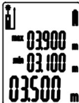
Jatkuva mittaus sammuu automaattisesti sadan mittauksen jälkeen (n. 30 sekuntia). Viimeisin mittaustulos jää näytölle. Peruuttaaksesi jatkuvan mittauksen, voit vaihtaa mittaustapaa painamalla painiketta **7 C/OFF**. Paina kerran pysäyttääksesi ja toisen kerran poistuaksesi.
