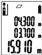
Efter avslutad andra mätning beräknas och visas ytan automatiskt.
