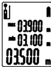
Den kontinuerliga mätningen slås automatiskt från efter 100 mätningar (cirka 30 sekunder). Det sista mätvärdet står kvar på displayen. För att avsluta den kontinuerliga mätningen, ändra mätfunktion genom att trycka på knappen **7 C/OFF**. Tryck en gång för att stoppa och en andra gång för att avsluta.
