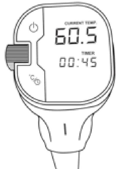
**NOTE:** Jos laitetta ei ole asetettu veteen ennen käynnistämistä, virhekoodi "EE1" ilmestyy näyttöön. Aseta se veteen ja aloittaa alusta.
